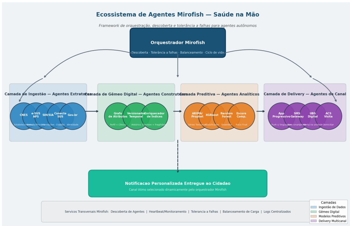
Figura 9: Ecosistema de agentes Mirofish: orquestração distribuída das quatro camadas — ingestão, gêmeo digital, previsão e delivery — com serviços transversais de descoberta, tolerância a falhas e balanceamento de carga.
